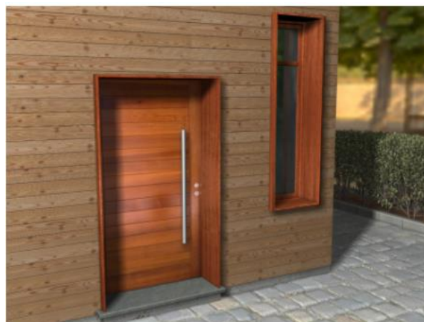
Figura 73: Modelo de aplicação de fachada ventilada revestida com réguas de madeira termotratada – Gestor de orçamentos Arquimedes da Cype 2025
