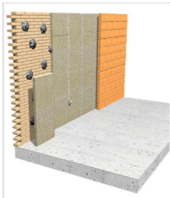
Figura 93: Modelo de isolamento térmico de painel semi-rígido de lã mineral pelo interior do pano exterior em fachada dupla de alvenaria de face à vista - Gestor de orçamentos Arquimedes da Cype 2025
