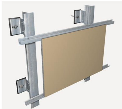
Figura 70: Modelo de aplicação de fachada revestida com placas de betão de polímero - Gestor de orçamentos Arquimedes da Cype 2025
