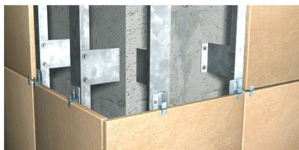
Figura 65: Modelo de aplicação de fachada ventilada revestida com placa de grés porcelanato - Gestor orçamentos Arquimedes da Cype 2025
