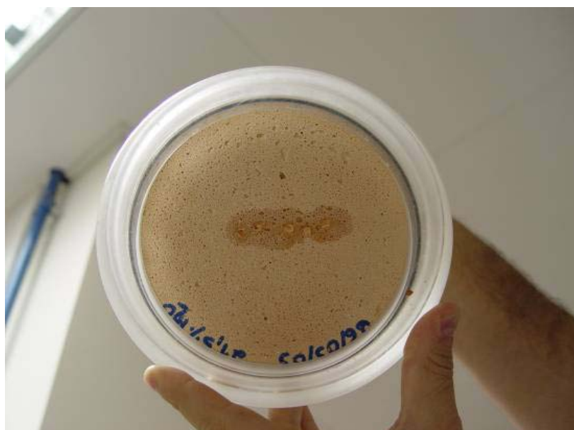
Figura 51 – Exemplo de uma argamassa com baixo poder de impermeabilidade [7]
