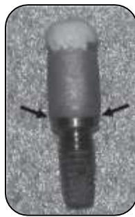
Fig. 15) Amostra após a selagem superior. Setas mostram interface implante-pilar (Nascimento et al. , 2008)
