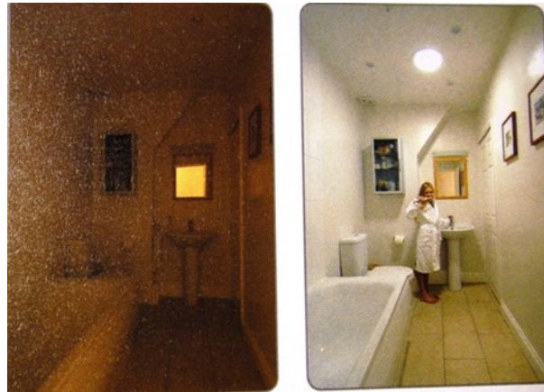
Figura 32: Iluminação por Conduta Zenitais, (Espaço interior sem conduta zenital e com conduta zenital)
