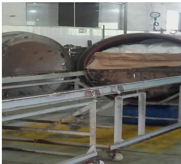
Figura 21 - Resíduos de serviços de saúde iniciando o processo de tratamento no equipamento de autoclave, do município de Santos.
