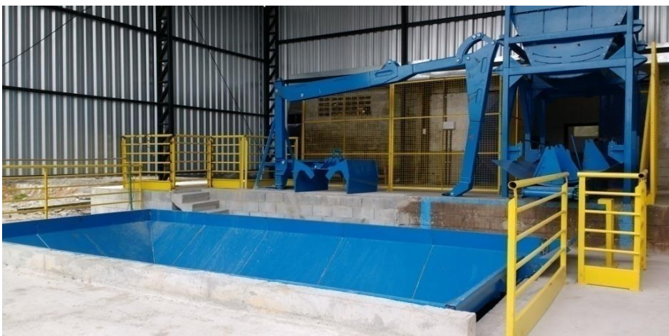
Figura 28 - Sistema de transporte interno dos resíduos de serviços de saúde do caminhão mecanizado para a autoclave, utilizado na unidade de tratamento do município de Santos, após visita técnica realizada na 2ª etapa.
