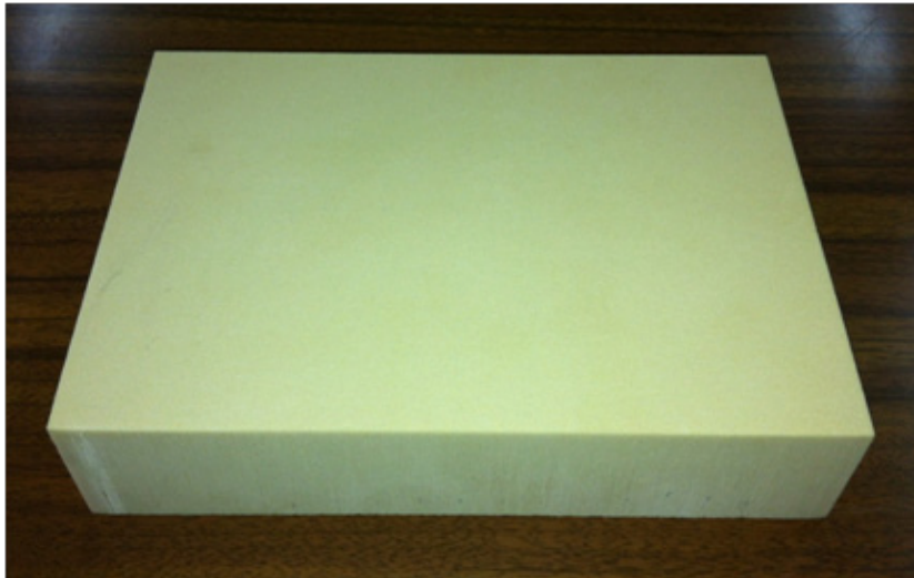
Figura 1 – Bloco da SawBones ® utilizado no estudo para simular osso humano tipo I.
