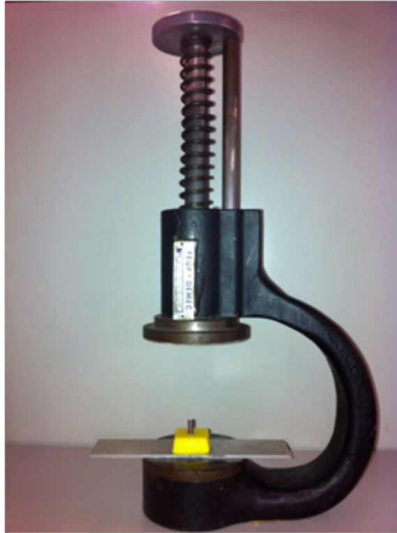
Figura 2 - Nivelador de amostras utilizado no processo de paralelização dos implantes.
