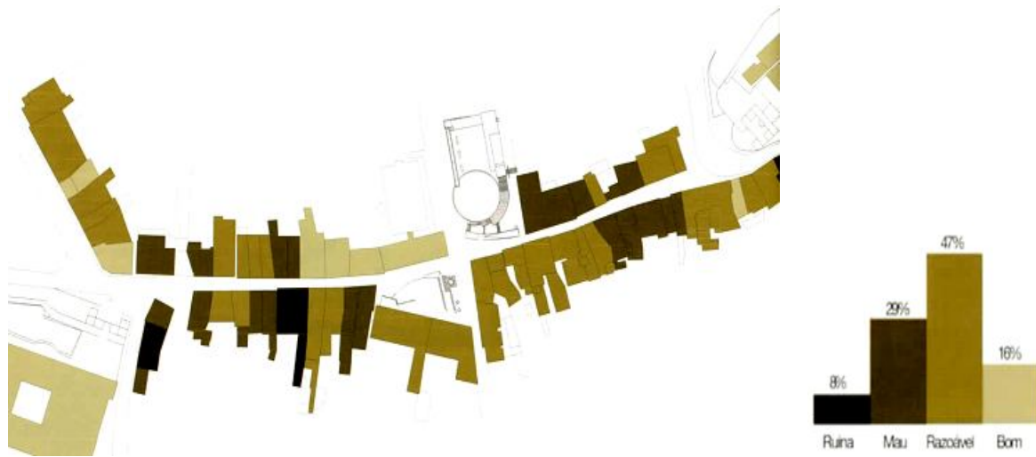
Figura 7.3 – Levantamento do estado de conservação dos edifícios ao longo da antiga rua Direita (Atlas, 2009).
