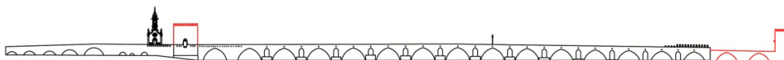
20 – Perfil longitudinal das pontes romana e gótica de Ponte de Lima, indicando a vermelho as torres que as flanqueavam (Torre da Ponte, à direita e Torre Velha, à esquerda) e os dois arcos soterrados no Largo de Camões
