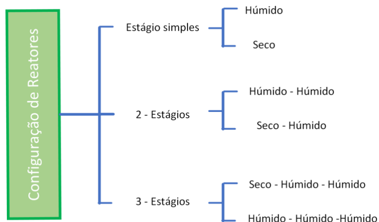
Figura 8 Combinação de digestores, para sistemas de DA simples e multi-estágio (adaptado de Van et al., 2020)
