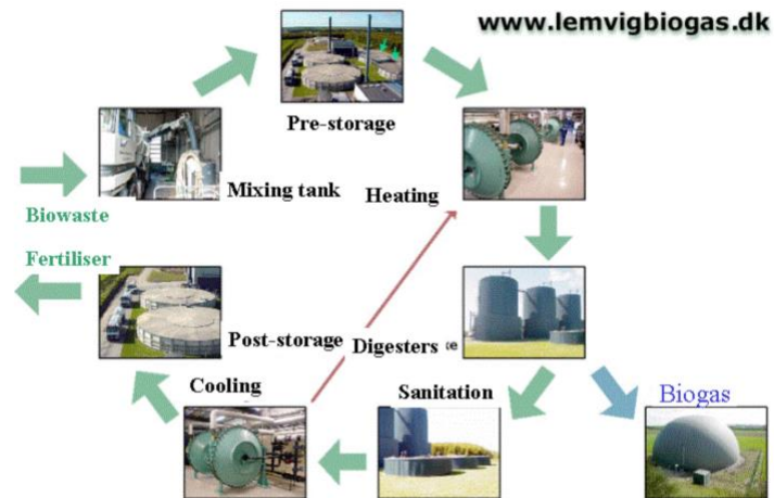
Figura 22 Unidade de produção de biogás de Lemvig – processo de digestão ( https://lemvigbiogas.com ).
