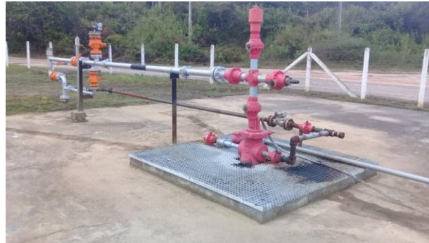
Foto 6 - Poço equipado com o método de elevação artificial Bombeio Centrífugo Submerso (BCS)
