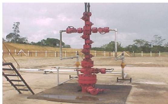
Foto 7 - Poço equipado com o método de elevação artificial Gás lift (GL)
