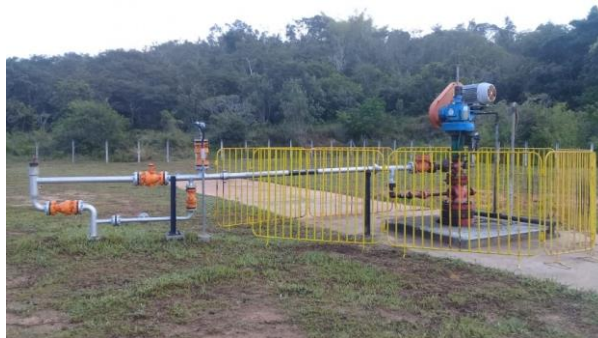
Foto 5 - Poço equipado com o método de elevação artificial Bombeio de Cavidades Progressivas (BCP)
