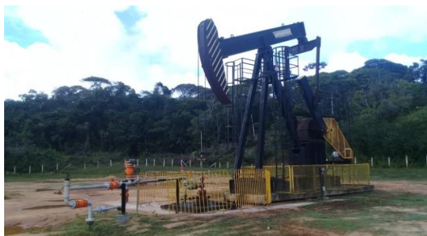
Foto 4 - Poço equipado com o método de elevação artificial Bombeio Mecânico (BM)
