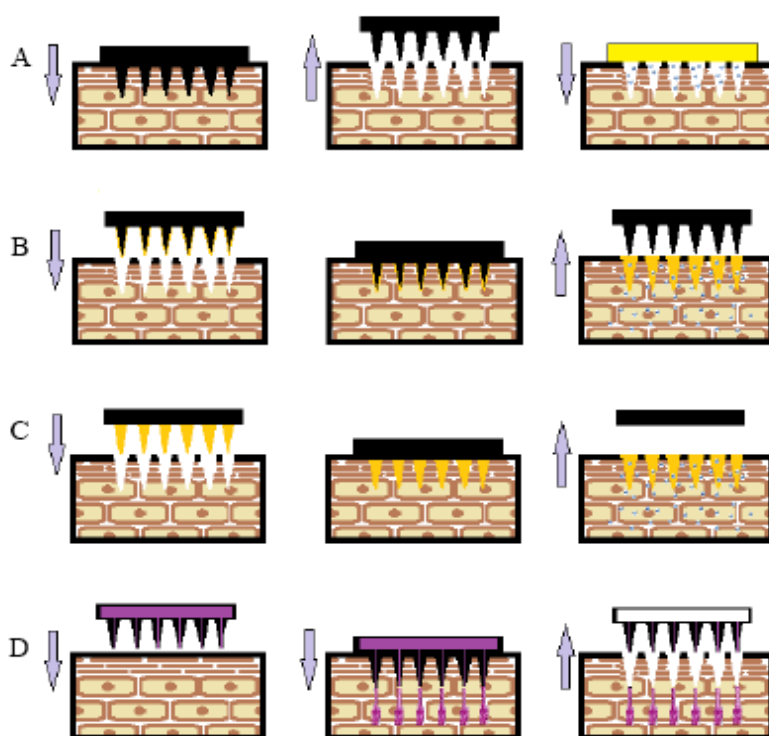
Figura 5: Esquema ilustrativo dos diferentes processos de aplicação das micro-agulhas através da pele. (A) processo de “ poke and patch ”, (B) processo de “ coat and poke ”, (C) processo de “ poke and release ” e (D) processo de “ poke and flow ”. Adaptado de Serrano-Castañeda et al. (2018).
