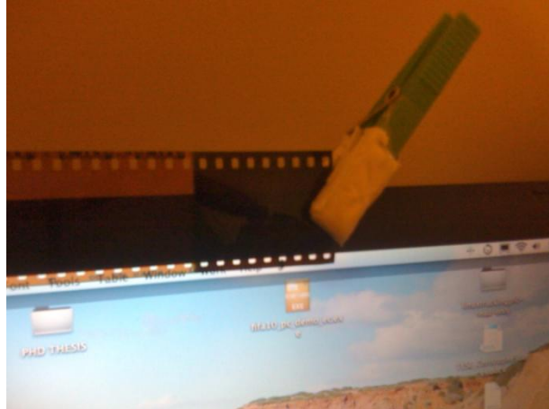
Figura 66: Colocação do Filtro em frente a câmara (IR Pass Filter)
