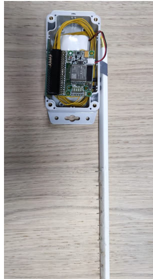
Figura 4.2: Edge Device - Separador de Gordura
