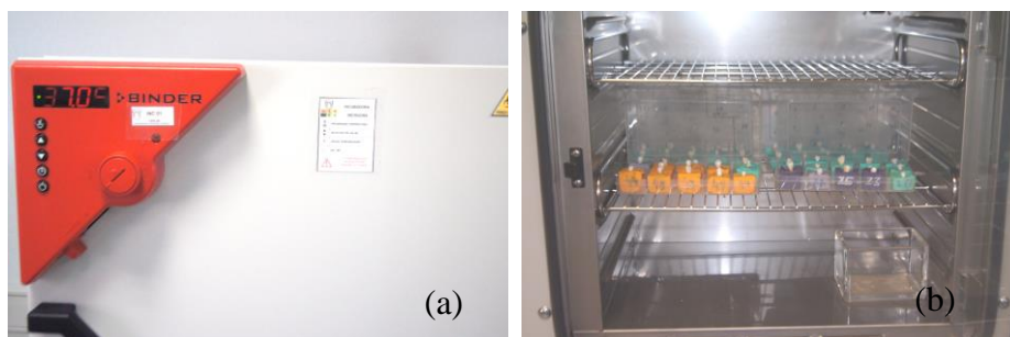
Figura 8: Colocação das peças dentárias na estufa a 37°C e 100% de humidade (a e b).
