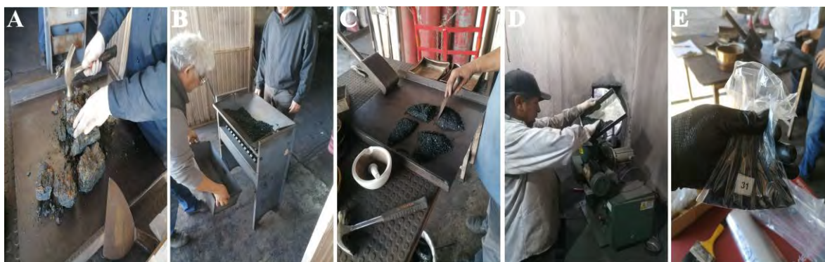
Figura 15. Proceso de preparación de muestras de carbón en el Laboratorio de Litopreparación del CIGA-UAdC.
