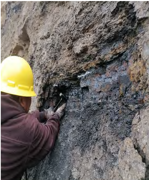
Obra minera a cielo abierto inactiva de la empresa CANESA, medición de los espesores de las capas de carbón, recolección de muestras de carbón mediante el método de canal, reconocimiento y descripción de la capa de carbón SP-01-M7 correspondiente a la Subcuenca San Patricio.
