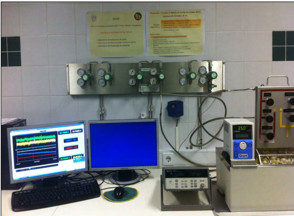
Figura 17. Instrumento de medición de adsorción/desorción de gases por el método termo-volumétrico en el laboratorio de la Universidad Fernando Pessoa.
