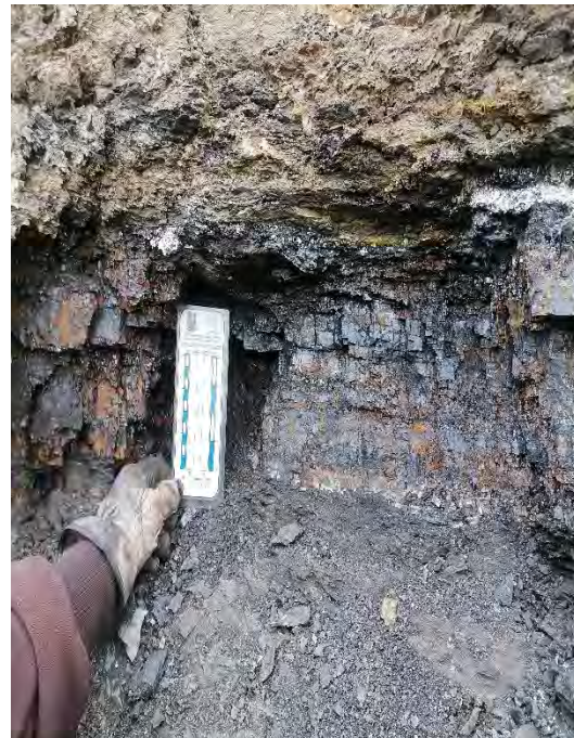
Obra minera a cielo abierto inactiva de la empresa CANESA, medición de los espesores de las capas de carbón, recolección de muestras de carbón mediante el método de canal, reconocimiento y descripción de la capa de carbón SP-01-M7 correspondiente a la Subcuenca San Patricio.
