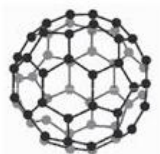
Ilustração 14: Estrutura de um fulereno (adaptado de Mihranyan et al , 2012).
