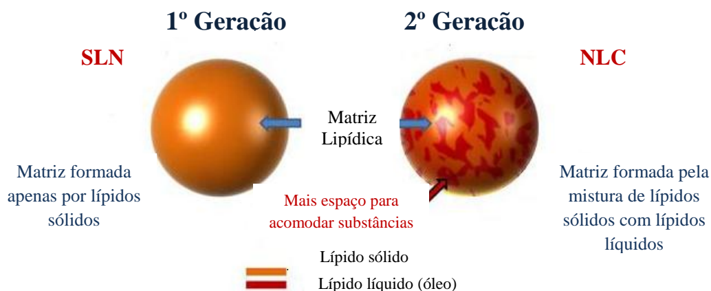
Ilustração 10: Diferenças entre a matriz das SLN e NLC (adaptado de Müller et al , 2011).
