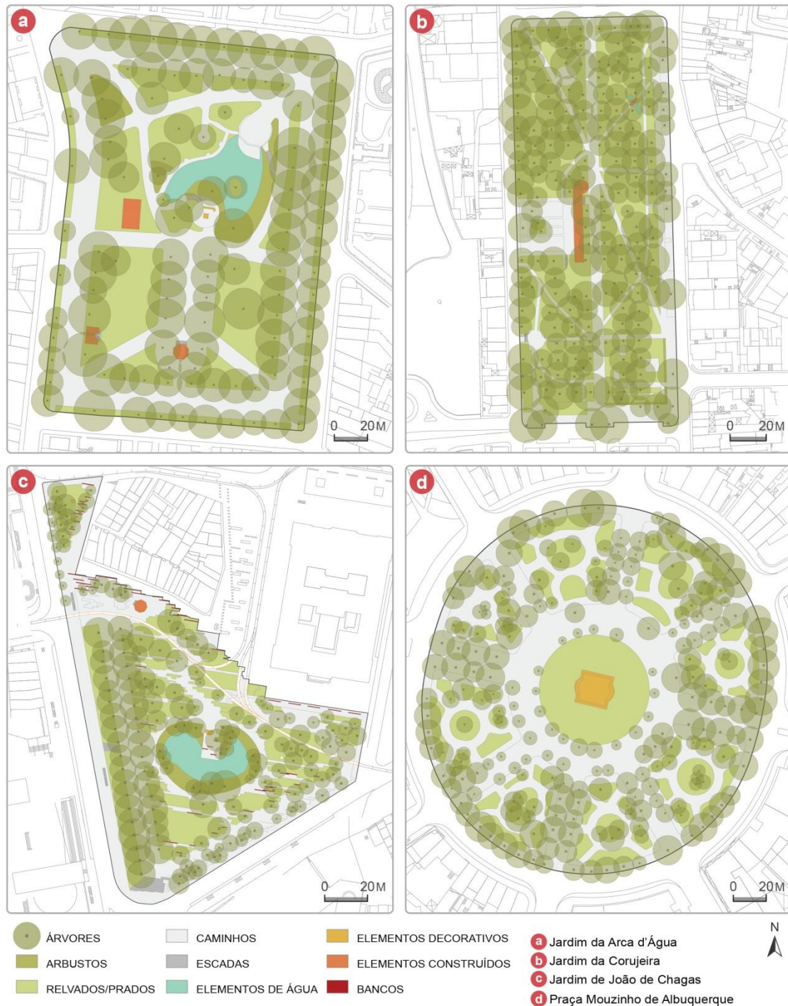
Figura 10 – Desenho, elementos naturais e mobiliário urbano nos quatro espaços verdes urbanos estudados.
