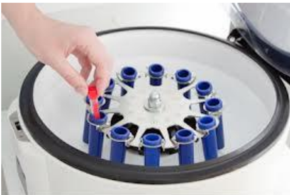
Figura 7: Centrifugação dos tubos de ensaio para separação das fases.
