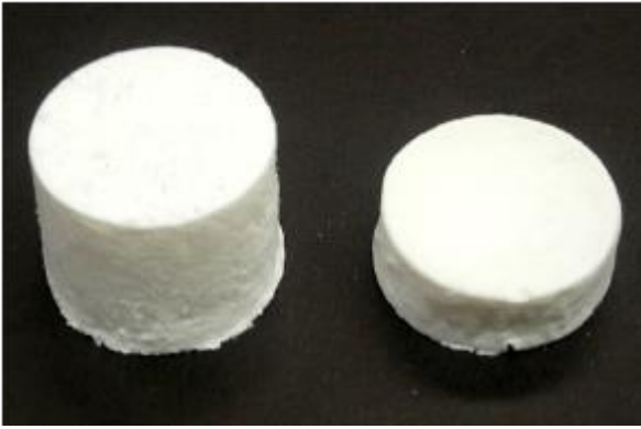
Figura 16: Scaffolds preparados por liofilização (Sultana e Wang, 2011).
