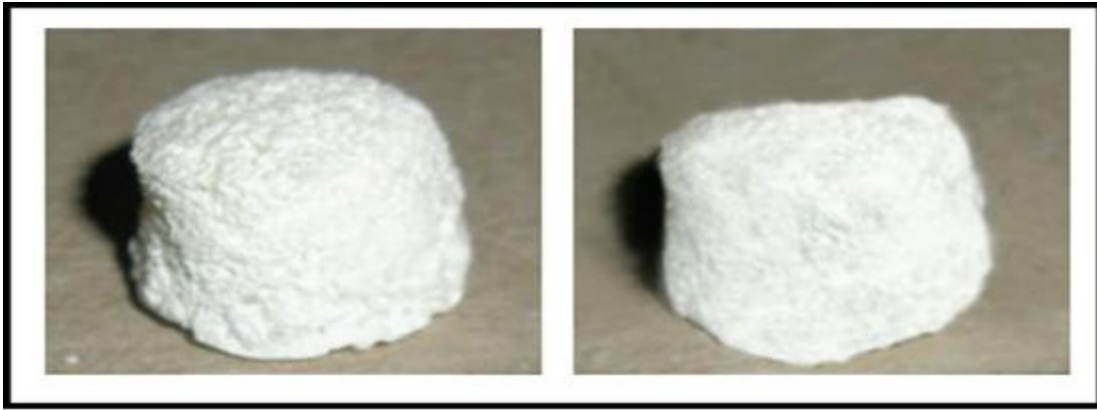
Figura 18: Scaffolds obtidos pelo método de lixiviação de partículas (Asti et al. 2010).
