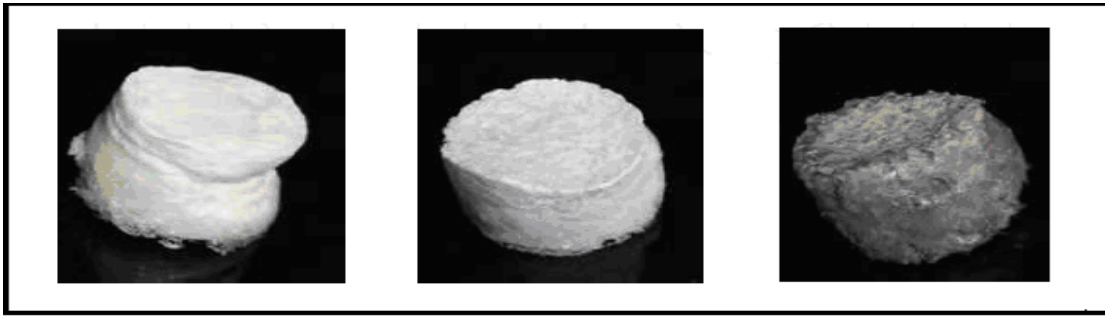
Figura 20: Scaffolds preparados por separação de fase (Martinez-Pérez et al. 2011).
