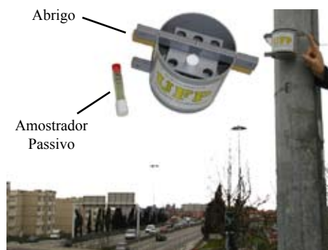
Figura 2 – Amostrador Passivo colocado num poste de electricidade da VCI (zona do Amial).
