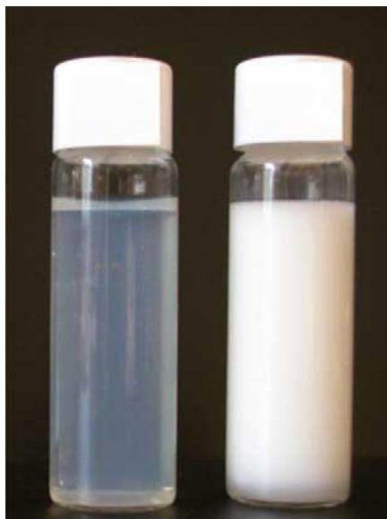
Figura 3 – Aspeto de uma nanoemulsão (à esquerda) e de uma emulsão convencional (à direita) com gotículas de 35 nm e de 1 \mu m, respetivamente. Retirado de Azemar et al , 2005.
