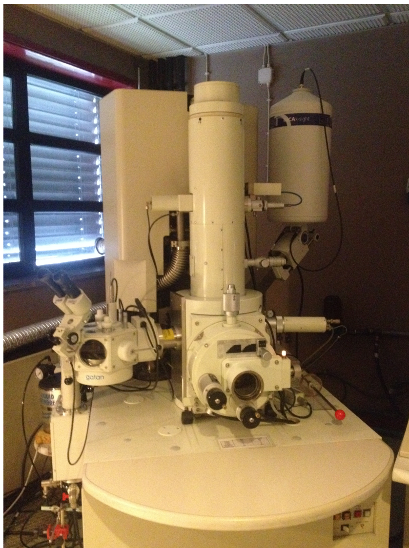
Figura 7 - Microscópio eletrônico de varrimento de alta resolução: JEOL JSM 6301F/ Oxford INCA Energy 350
