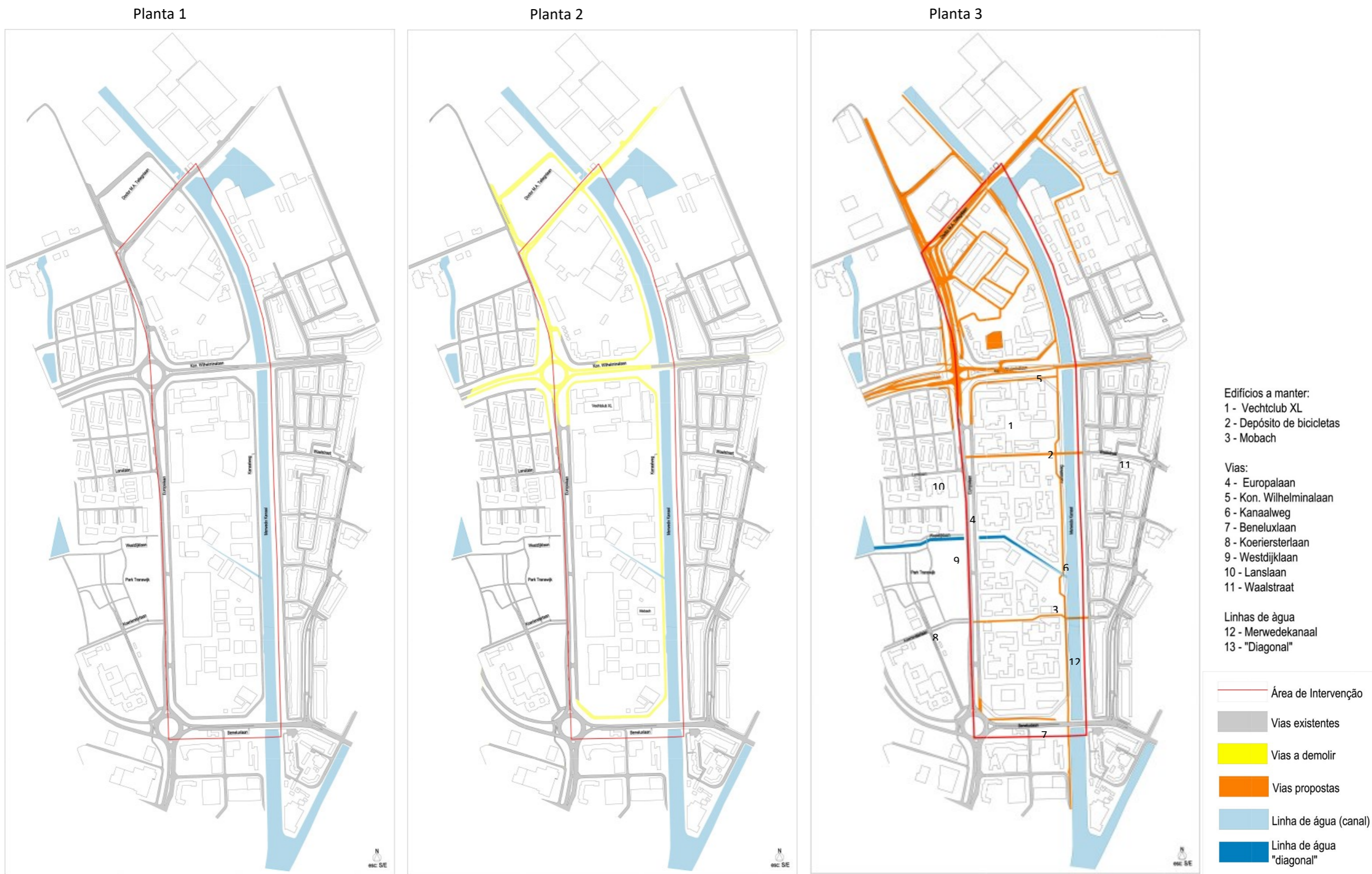
Figura 96 - Representação de arruamentos: planta 1 – Arruamentos em 2005; planta 2 – Arruamentos a demolir; planta 3 – Arruamentos a construir (proposta do plano)
