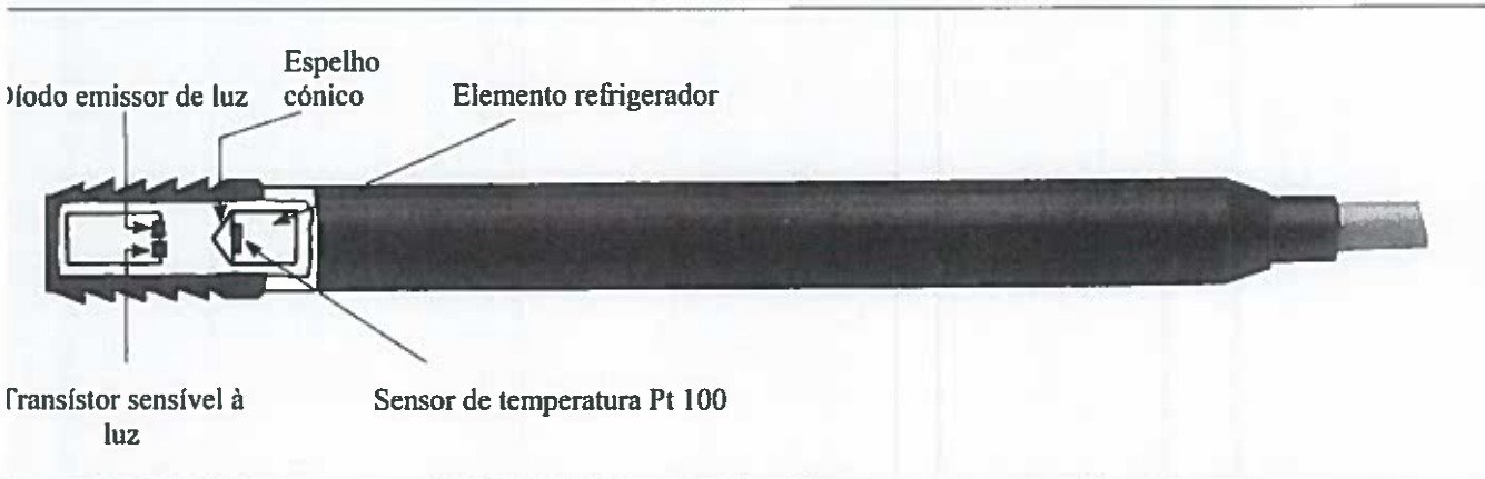
Figura J. 4. Transdutor de Humidade. (Adaptado de: Bruel & Kjaer, 1990)
