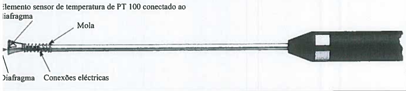
Figura J. 2. Sonda de Medição da Temperatura Superficial. (Adaptado de: Bruel & Kjaer, 1990)
