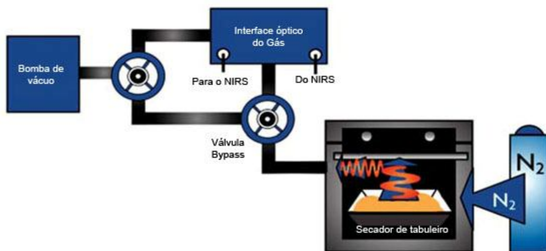
Figura n.º 13 - Diagrama do secador de bandeja equipado com célula óptica de interface de gás.
