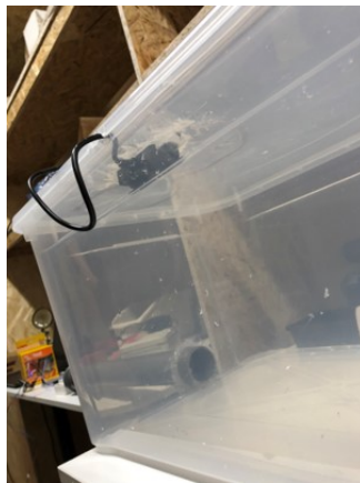
Figura 3.9: Sensor de ultrassons montado no protótipo do bueiro
