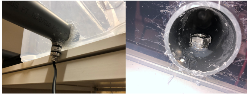
Figura 3.5: Protótipo de bueiro para medição da pressão da água em função do entupimento
