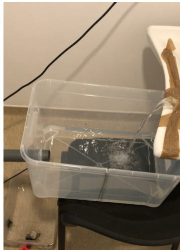
Figura 3.6: Testes no protótipo de bueiro com a introdução de água
