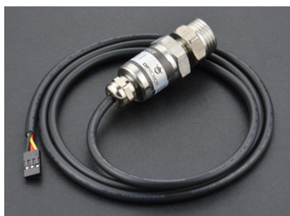
Figura 2.5: Sensor de Pressão de Água
