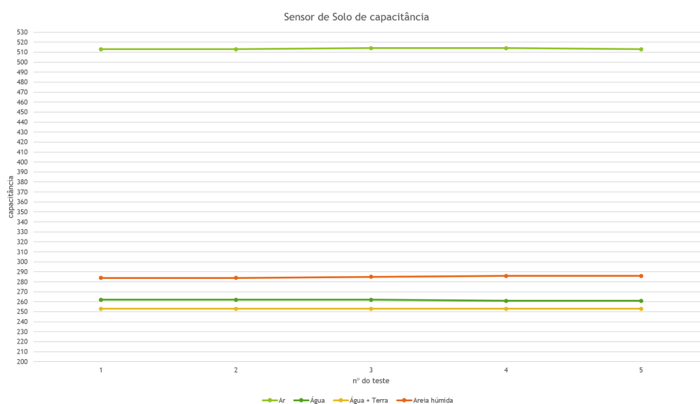
Figura 3.12: Gráfico do teste do sensor capacitivo de humidade de solo
