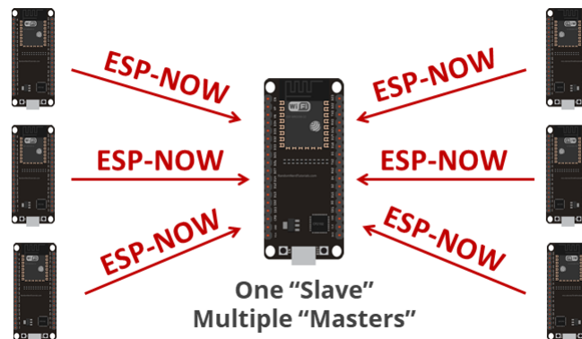
Figura 3.16: Comunicação masters-slave via ESP-NOW
