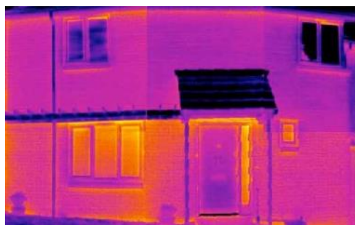
Figura V. 16 – Imagem termográfica da construção convencional (Yates, 2003, p. 12)
