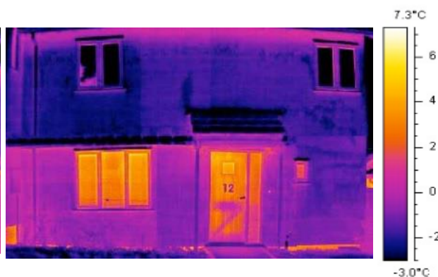
Figura V. 17 – Imagem termográfica da construção em cânhamo (Yates, 2003, p. 14)
