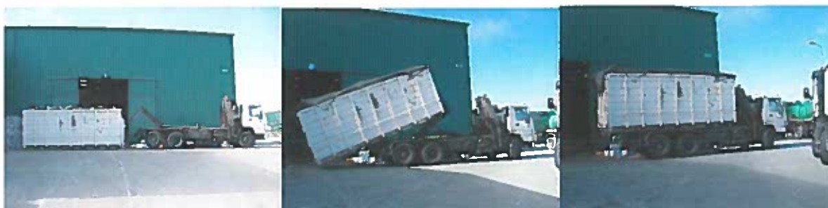
Figura II.1.16. – Sequência da operação de carregamento do contentor que contém o refugo, para deposição em AS.
