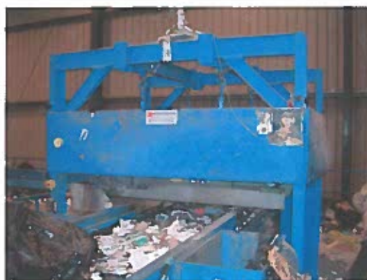
Figura II.1.13. – Separador magnético colocado no fim da mesa de triagem.
