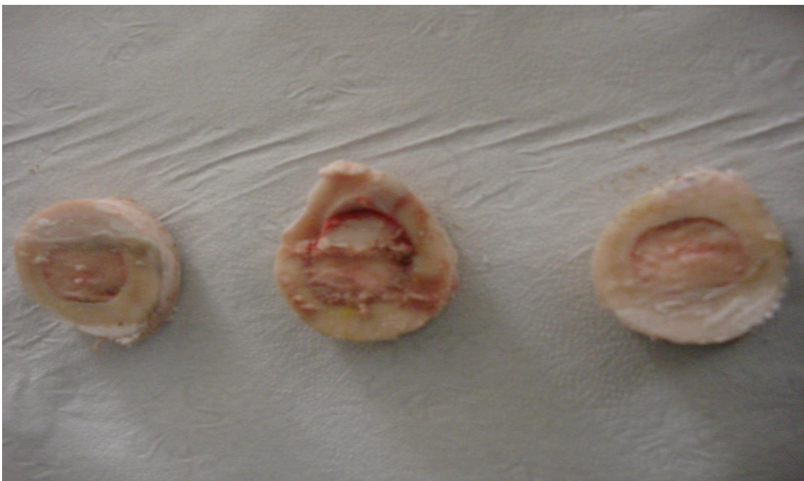
Figura 03: Fémur de bovino seccionado em amostras circulares
