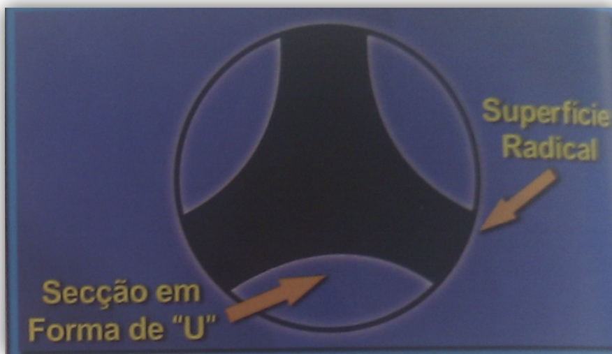
Fig.2- Três superfícies radiais dos instrumentos do sistema Profile (Estrela)
