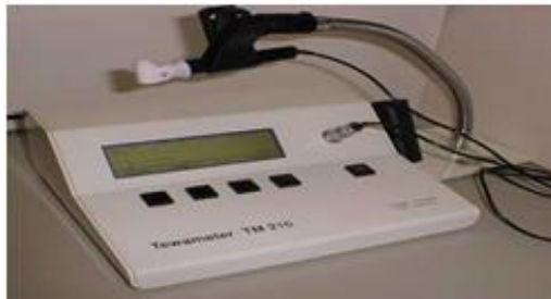
Figura 13 - Tewameter utilizado na determinação da TEWL.
