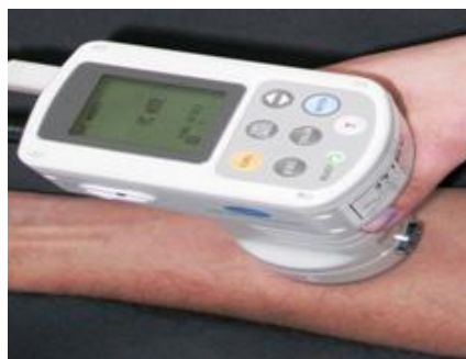
Figura 14 - Colorímetro utilizado na determinação do grau de eritema.
