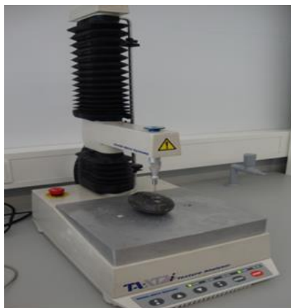
Figura 10 - Modelo do texturómetro utilizado na avaliação da dureza.
