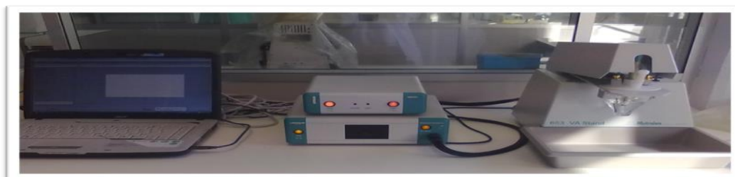
Figura 9 - Potencióstato Ecochimie/Autolab modelo \mu Autolab Type III acoplado com um Stand da Metrohm 663 VA.
