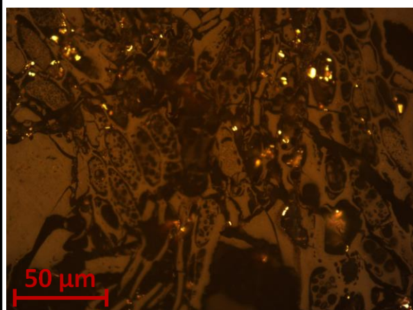
Microfotografía 3. Inertinita, vitrinita y piirita framboidal observadas en microscopia óptica en luz reflejada natural en inmersión de aceite.
