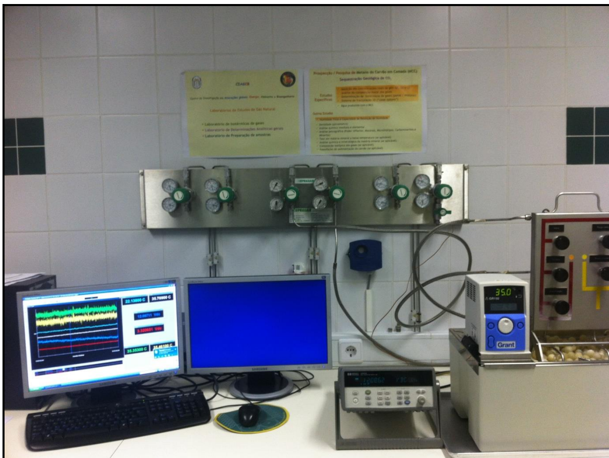
Figura 25. Fotografia de instrumento de medición de Adsorción/Desorción por el método termo-volumétrico. Universidade Fernando Pessoa.
