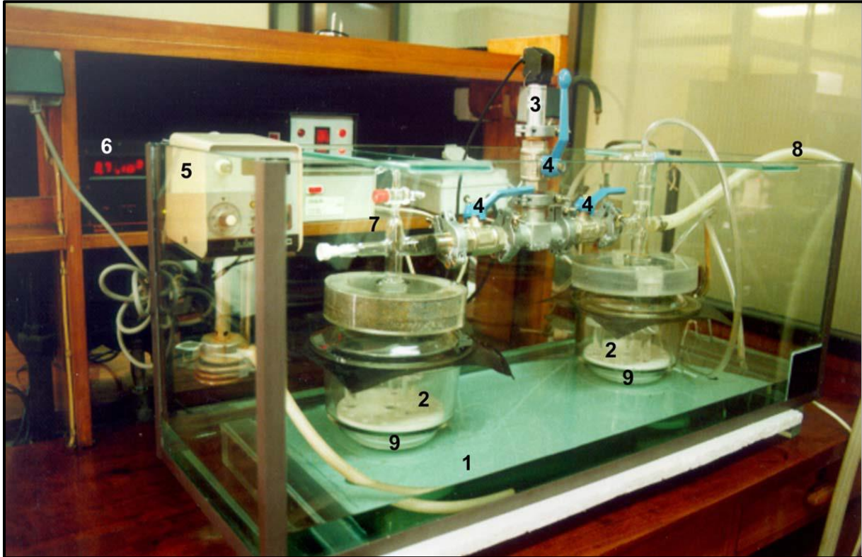
Figura 24. Fotografía del instrumento de medición de MHC. Faculdade de Ciências de la Univesidade do Oporto Portugal. 1. Baño de agua; 2. Desecadores; 3. Transductor de presión; 4. Válvulas de conexión; 5. Termostato; 6. Sistema de adquisición de datos; 7. Termopar; 8. Tubo de alimentación de la bomba de vacío; 9. Solución saturada de sulfato de potasio
