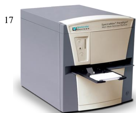
Figura 12 e 13 – Utilização de Micropipetas para o manuseio das soluções reagentes; Figura 14 – Fixação do espécime em cera para manuseio e aplicação das soluções; Figura 15 – Vedamento com barreira gengival fotopolimerizável; Figura 16 – Aplicação do gel clareador; Figura 17 - Multileitora Spectramax Paradigm. (Disponível em: www.lameb.ccb.ufsc.br/spectramax-paradigm/ . Data de acesso: 08/05/2018) *Imagens do autor, excepto 17.
