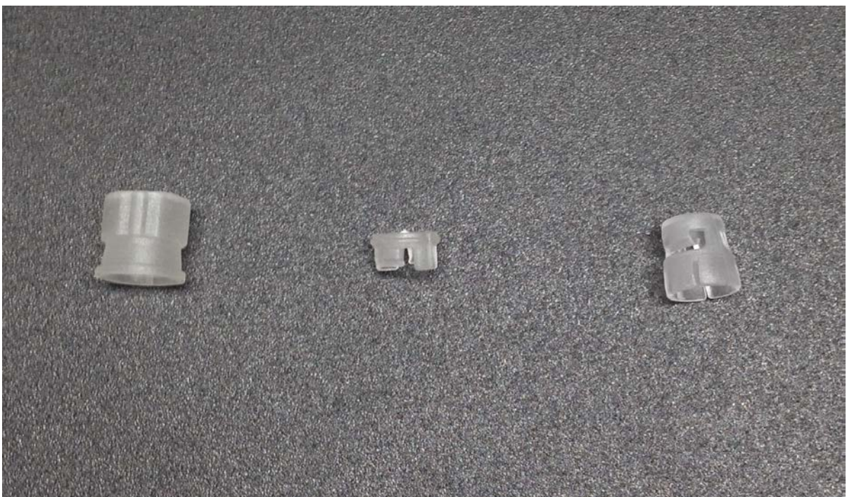
Foto 5 – Protótipos da matriz em plástico poliamida
